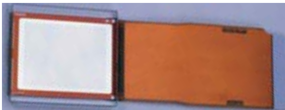
La matrice D-ILA de JVC, d'une résolution de 2048 x 1536 pixels et d'une diagonale de 1,3 pouce.
