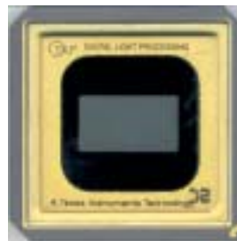
Matrice DMD constituée de miroirs microscopiques.
