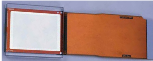
Die D-ILA-Matrix von JVC mit einer Auflösung von 2048 x 1536 Pixeln bei einer Diagonalen von 1,3 Zoll.
