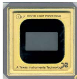
DMD-Matrix bestehend aus winzigkleinen Spiegeln.
