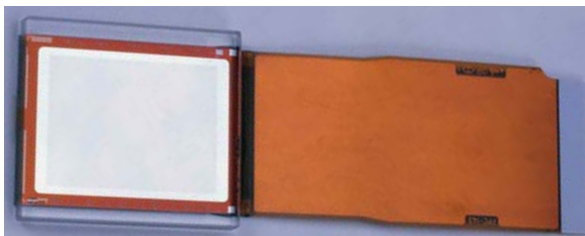
La matrice D-ILA di JVC, con una risoluzione di 2048 x 1536 pixel e una diagonale di 1,3-pollici.
