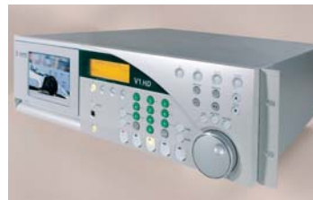
Servidor Doremi V1-HD compatible con el formato JPEG 2000.
