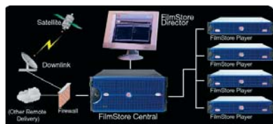
Esquema de principio de una red de servidores Avica.
