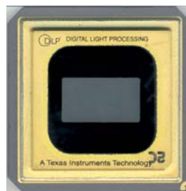
Matriz DMD constituida de microespejos.
