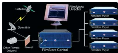
Diagramma della rete di server Avica
